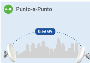
EnJet proporciona un rendimiento estable de forma más consistente que las conexiones CSMA estándar al ordenar las transmisiones en diferentes ranuras de tiempo.
